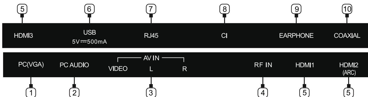
1. **VGA** – видеовход для подключения компьютера
