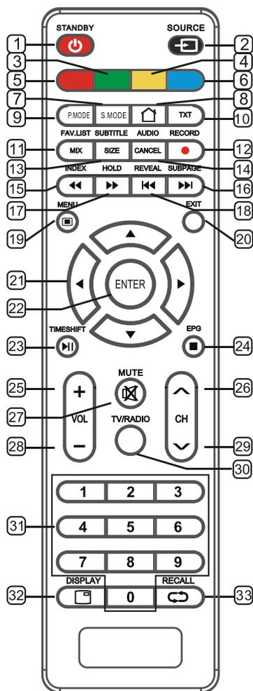
1. **STANDBY** Кнопка включения телевизора / перехода в режим ожидания.
