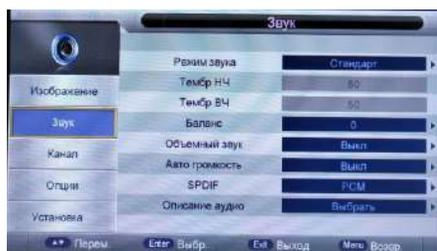
**Режим звука** – Выберите подходящий режим в зависимости от типа просматриваемых передач: Стандартный, Фильмы, Музыка или Пользовательский. Вы также можете изменить режим изображения, последовательно нажимая кнопку S-MODE на пульте ДУ.
