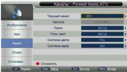
**Текущий канал** – Установите номер канала, с которого нужно начать поиск.
