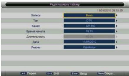
В открывшемся меню включите начало видеозаписи, установите режим телевизора, телеканал, время начала видеозаписи, ее продолжительность, дату, а также режим видеозаписи (разовый или регулярный). Вы можете запланировать запись нескольких передач, при этом будьте внимательны: время передач не должно накладываться одно на другое. Телевизор может осуществлять видеозапись независимо от того, включен
