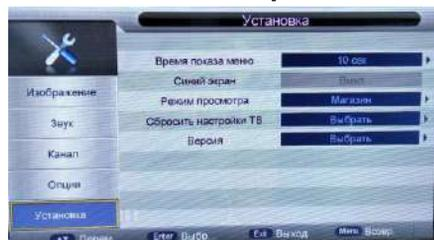
**Таймер отображения экранного меню** – Установите время отображения экранного меню (от 5 до 30 секунд), по истечении которого при отсутствии операций оно будет исчезать с экрана. Если вы отключите данную функцию, меню не будет исчезать автоматически.
