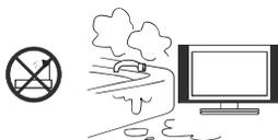
Не используйте телевизор вблизи воды, например, рядом с раковиной, мойкой или стиральной машиной, во влажном подвале, вблизи бассейна и т. д. После транспортировки в условиях низкой температуры перед включением телевизора дайте выдержку около часа при комнатной температуре, не включайте телевизор сразу, так как это приведет к образованию конденсата, что может вызвать пожар, поражение электрическим током или другие последствия.
