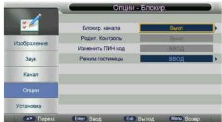
**Блокировка каналов** – Вы можете включить или отключить функцию блокировки каналов. (Чтобы выбрать канала для блокировки, перейдите в Меню настроек телеканалов, Редактирование телеканалов).
