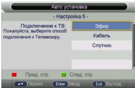
9. Выберите режим поиска: поиск всех телеканалов (Все), поиск каналов аналогового телевидения ATV или каналов цифрового телевидения DTV. Затем нажмите кнопку **ENTER**, чтобы начать автоматический поиск и сохранение телеканалов.
